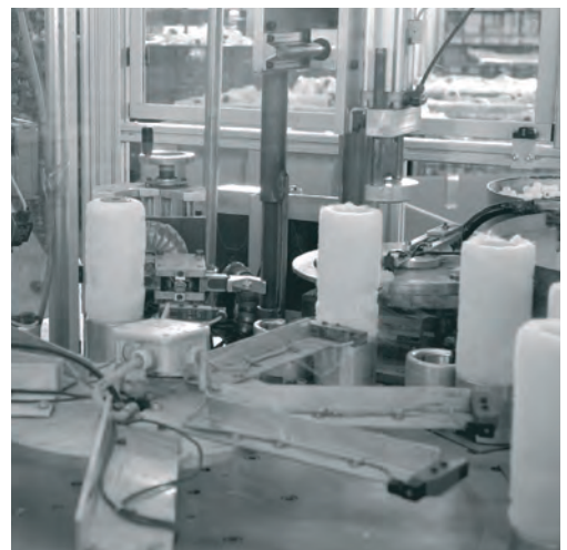
Montageeinheit zur Bestückung mit Innenteilen und Endstücken
