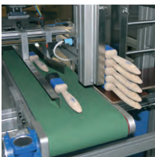
Pinsel in Ausputzmaschine einfüllen
