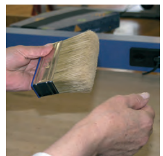
Qualitätsprüfung: Sauber ausgeputzt, keine sonstigen Fehler?
