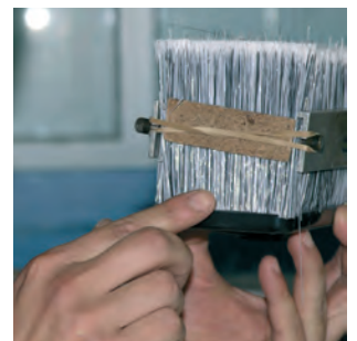
Verleimen des Borstenbesatzes mit dem Bürstenkörper
